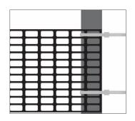
• Сетка крепится к опорам хомутами. Для предотвращения провисания сетки и увеличения прочности конструкции сетку рекомендуем укрепить проволокой толщиной не менее 4 мм, протянув ее по верхнему и нижнему краю ограждения.
