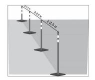
• При строительстве временных мобильных ограждений в качестве опоры для сетки применяются пластиковые вехи с резиновыми или полимерпесчаными подставками. Вехи устанавливаются на расстоянии 2-2,5 м. Для продолжительного функционирования ограждения опорой для сетки будут металлические стержни или столбы, закрепленные в земле.
